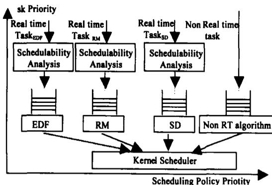
图 1 二维优先级实时调度机制体系结构
